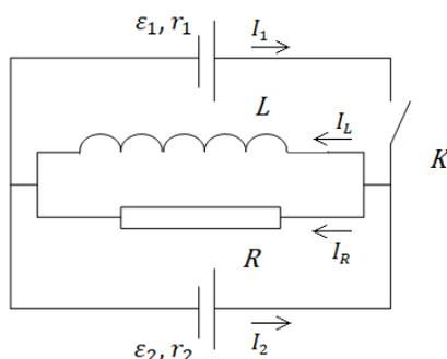
Сила тока через катушку до и сразу после замыкания ключа  $K$  одинаковая, она равна  $I_0 = \frac{\varepsilon_2}{r_1}$ .
